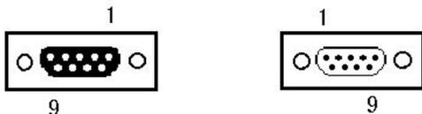
ATC-106 型转换器采用 DB9 型的母头连接器与 RS-232 接口相连, 其中 7、8 引脚 1、4、6 引脚短接。另一端 DB9 公头连接器
